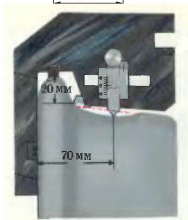
для измерения параметров гребня и глубины ползуна. При измерении движок шаблона ставят в наиболее глубокое место ползуна, а затем на катания бандажа разность этих замеров и есть глубина ползуна (выбоины).
