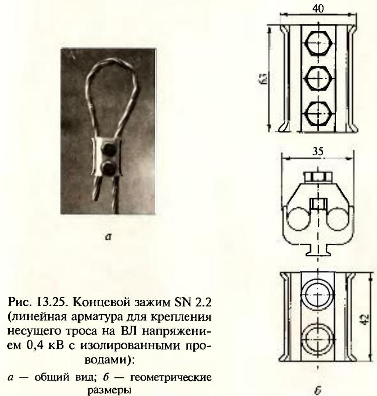
Рис. 13.25. Концевой зажим SN 2.2 (линейная арматура для крепления несущего троса на ВЛ напряжением 0,4 кВ с изолированными проводами):
