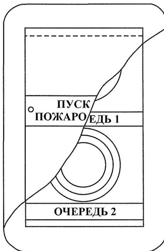
Рис. 3.3. Пост дистанционного пуска генератора установки газового пожаротушения
