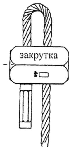
Рис. 1.22. «Закрутка» в замкнутом состоянии
