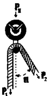
Через один карабин. Угол перегиба каната через карабин должен быть не более  $90^\circ$ . При значении  $\alpha$  от  $0^\circ$  до  $30^\circ$ :
