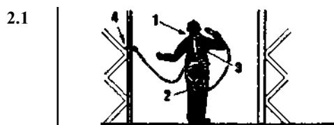
Работник обязан осуществлять присоединение карабина за несущие конструкции, обеспечивая свою безопасность за счет непрерывности самостраховки при горизонтальном перемещении по конструкциям на высоте в случаях, когда невозможно организовать страховочную систему.
