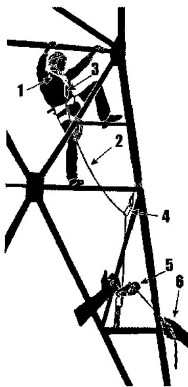
Работник обязан осуществлять организацию временных анкерных точек с фактором падения не более 1 (схема 1 приложения N 10), при перемещении по конструкциям и высотным объектам с обеспечением своей безопасности вторым работником (страхующим).
