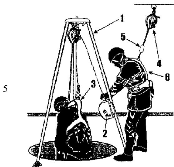
Система спасения и эвакуации, использующая переносное временное анкерное устройство.
