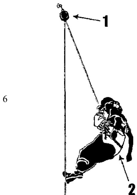
Система спасения и эвакуации, использующая индивидуальное спасательное устройство (ИСУ), предназначенное для спасения работника с высоты самостоятельно.
