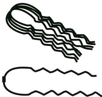
Рис. 6.37. Спиральная пружинная вязка для крепления провода SAX к штыревому
