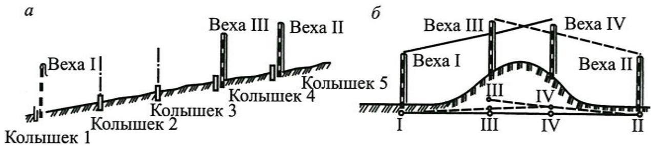
Рис. 6.8. Схема разбивки трассы ВЛ СЦБ 10 кВ
