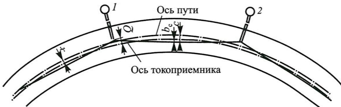
Рис. 5.11. Схема определения выноса контактного провода в кривой
