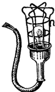
Рис. 104. Переносный низковольтный светильник
