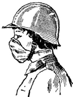
Рис. 96. Противопылевой респиратор «Лепесток»
