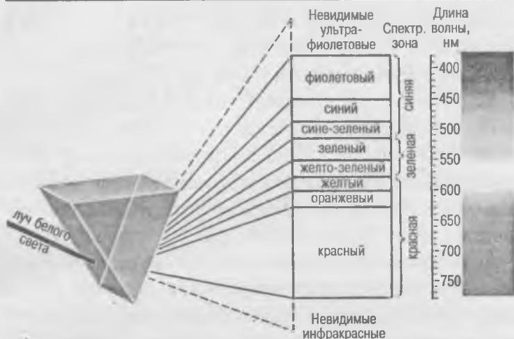
Рис. 29. Спектральное разложение светового луча
