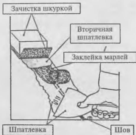
Рис. 45. Заделка стыков
