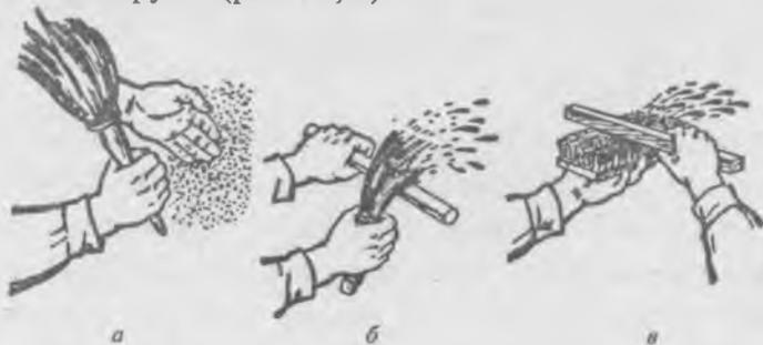
Рис. 77. Приемы обработки поверхности набрызгом:
