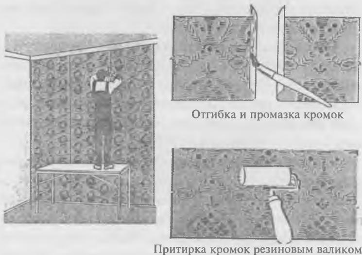
Рис. 57. Проклейка кромок наклеенных полотнищ
