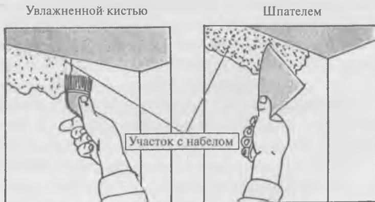
Рис. 44. Удаление набела с оштукатуренных стен
