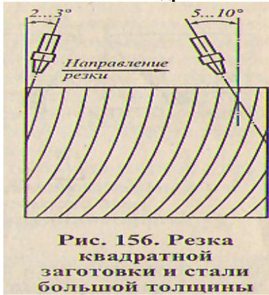
**Рис. 156. Резка квадратной заготовки и стали большой толщины**
