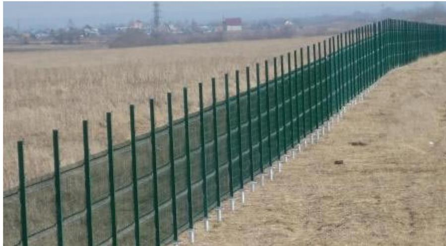
Рис. 10. Пример прозрачного гибкого полотна инженерного заграждения.
