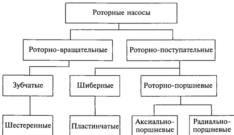
Рис. 12.3. Классификация роторных насосов
