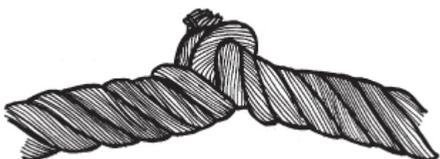
Рис. 14. Перекручивание каната
