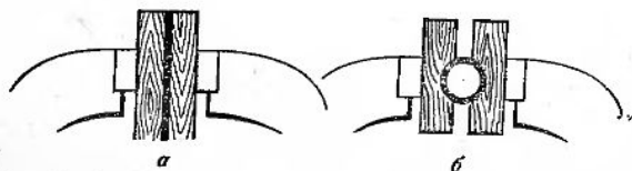
Рис. 88. Закрепление в тисках листового материала (а) и тонкостенной трубы (б).
