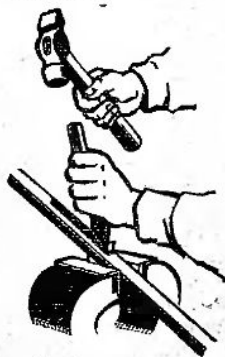
Рис. 78. Прорубание шпоночной канавки.
