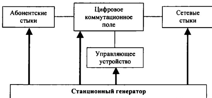
Рис. 7.6. Синхронизация цифровой АТС независимым станционным генератором
