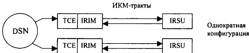
Рис. 6.10. Конфигурация однократного доступа
