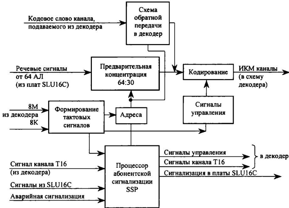
Рис. 4.4. Структурная схема кодера SUC
