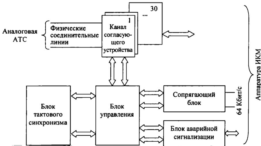
Рис. 4.15. Схема согласующего устройства
