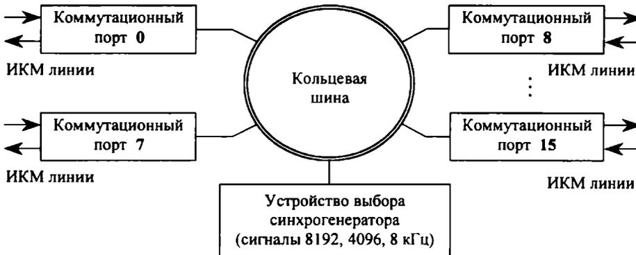
Рис. 2.25. Структурная схема ЦКЭ
