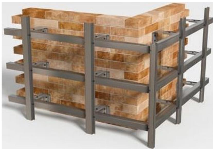
**Рис. 9.** Горизонтальная и вертикальная подсистемы внешней облицовки.
