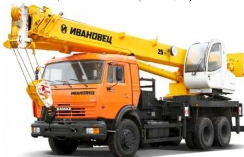
Рисунок 81 – автомобильный кран КС-45717К-1Р
