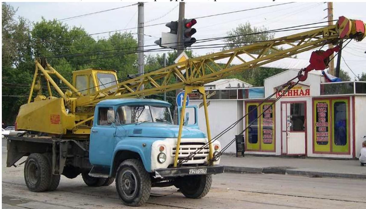
Рисунок 61 – Автомобильный кран КС-2561 на базе автомобиля ЗиЛ-431412
