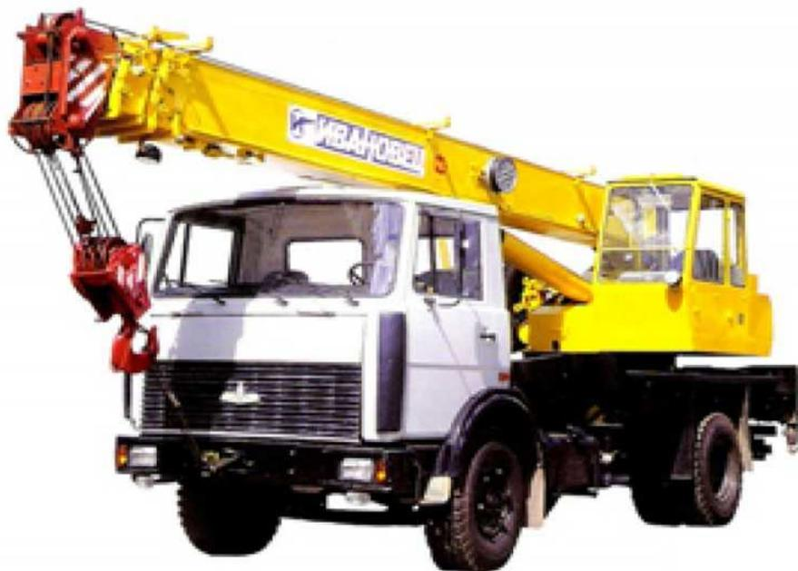
Рисунок 62 – Автомобильный кран КС-3571 на базе автомобиля МАЗ
