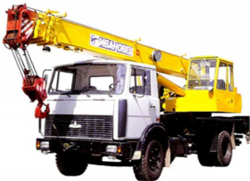
Рисунок 62 – Автомобильный кран КС-3571 на базе автомобиля МАЗ
