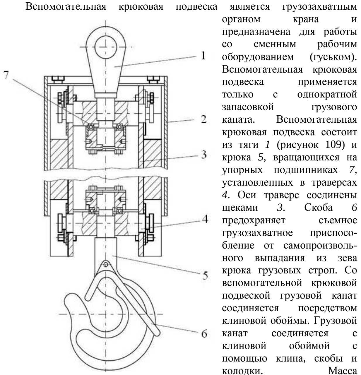
Рисунок 109 – Подвеска крюковая вспомогательная: 1 – тяга, 2 – кожух, 3 – щека, 4 – траверса, 5 – крюк, 6 – скоба, 7 – подшипник
