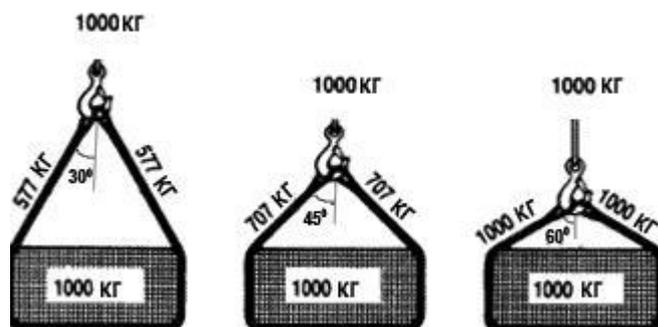
Натяжение ветвей строп рассчитываются и испытываются с углом 90°
