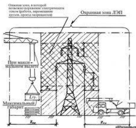
Если опасная зона ЛЭП приближена к работам крана ее обозначают шестами с сигнальными флажками
