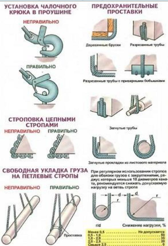
Такелажные узлы должны быть простыми с учетом удобства строповки и расстроповки и надежности
