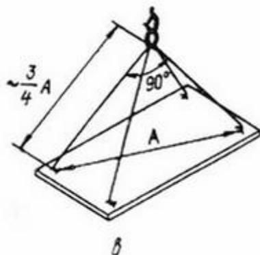
По схеме строповки, если ее нет, то длина ветвей строп должна быть не менее  $\frac{3}{4}$  расстояния между местами строповки и г/п не менее веса поднимаемого груза
