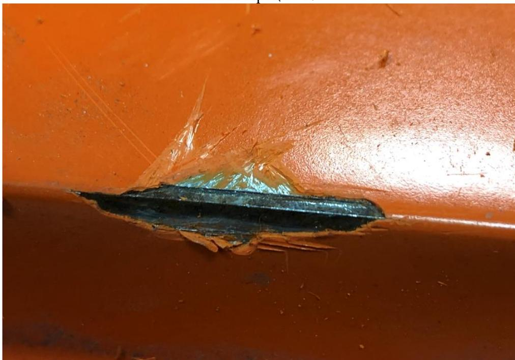
При более подробном исследовании области специального изделия (фасадной панели), свободной от лакокрасочного покрытия, видно место сопряжения двух плоскостей листового металла, из которых была собрана деталь (иллюстрация 18).
