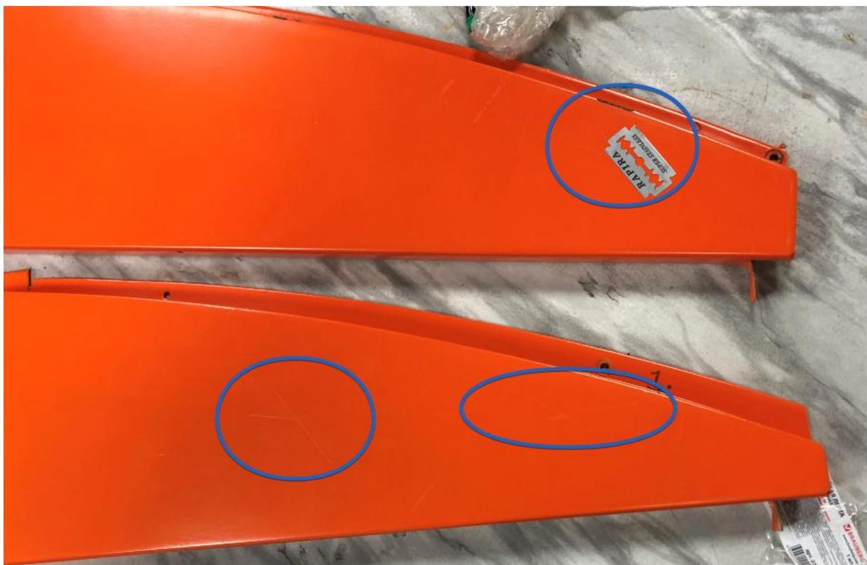
Обработка результатов проведенного исследования адгезии специальных изделий (фасадных панелей) показала отсутствие отслаивания или удаления покрытия в местах проведения испытаний, что соответствует оценке результатов испытаний – 0 баллов (Приложение А, ГОСТ 32702.2-2014).
