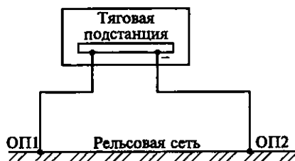
Рис. 5.40. Схема рельсовой сети с двумя пунктами присоединения отрицательных кабелей ОП1 и ОП2
