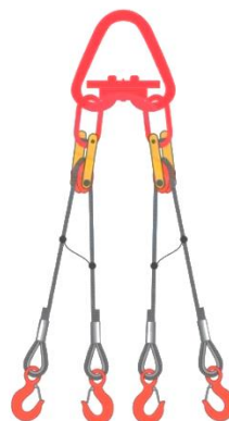
Рис. 5.2 Многоветвевые стропы: а - двухветвевой, б - четырехветвевой
