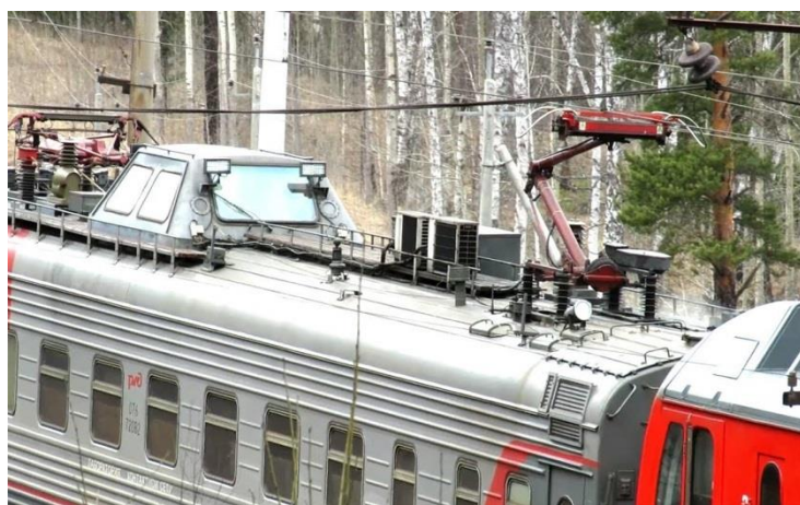
Рис. 5.35 - Вагон для испытаний контактной сети.
