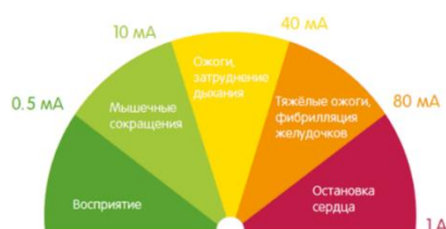
Рис. 7.1 - Предельные значения действия тока на человека
