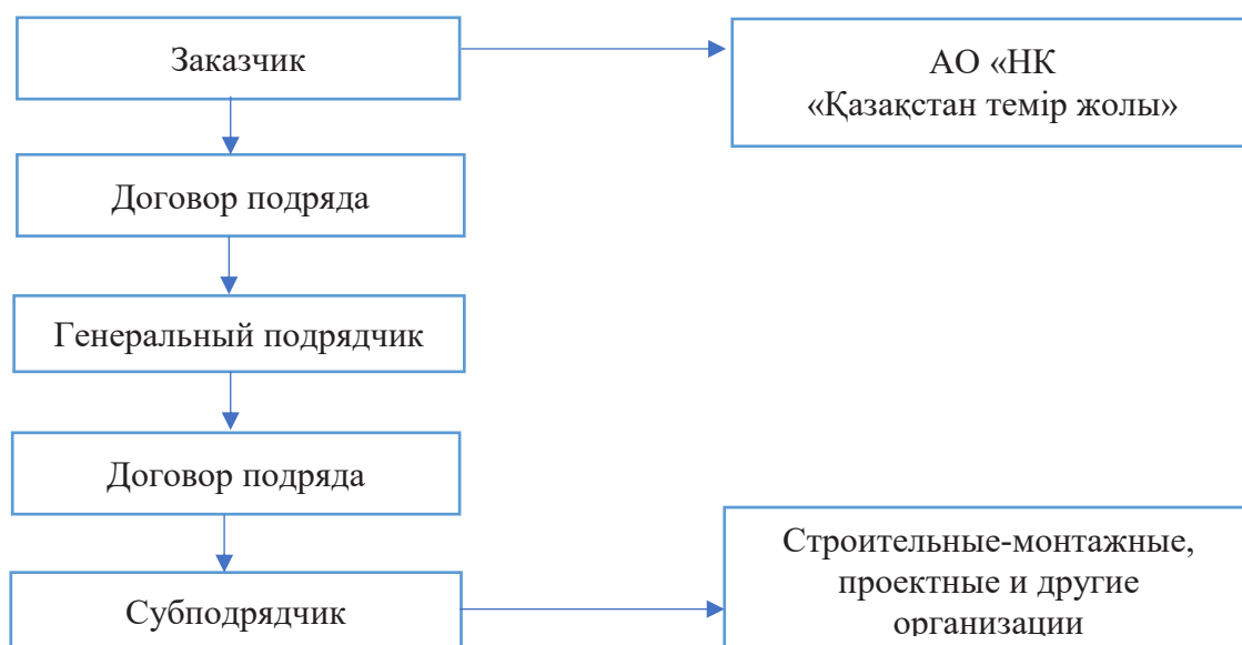
Рисунок 6.13 - Структурная схема подрядного способа производства строительных-монтажных работ при электрификации железных дорог
