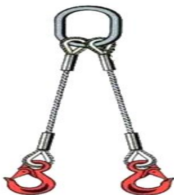
Рис. 5.2 Многоветвевые стропы: а - двухветвевой, б - четырехветвевой
